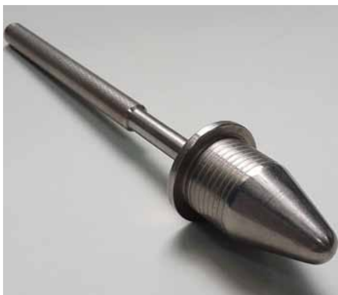
Рис. 1. Устройство для формирования проксимальной части сосудистого протеза.
