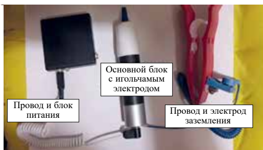
Рисунок 2. Внешний вид портативного генератора низкотемпературной плазмы атмосферного давления
