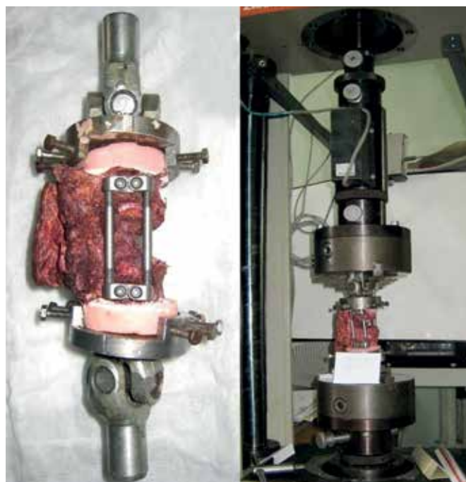
Рисунок 3. Анатомический препарат Th12-L2 с имитацией нестабильного повреждения Th12 и вентральной бисегментарной фиксации, установленный в испытательную машину Zwick 1464
